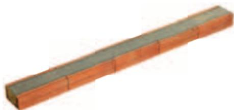
Керамобетонные перемычки Porotherm 120/65 применяются в оконных и дверных проёмах. Практически не уступая обычным железобетонным перемычкам в прочности благодаря железобетонной сердцевине и применению бетона высокой марки, керамобетонные перемычки Porotherm 120/65 выгодно отличаются от них:
