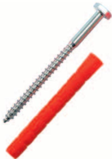
TOX Bizeps – анкерное решение для крепежа металлических конструкций, элементов из дерева, раковин, бойлеров, радиаторов, опорных консолей, обладающее высокой несущей способностью в пустотелых строительных материалах. TOX Bizeps отличаются уникальной объемной системой с удлиненной зоной распора в 90 мм, что позволяет крепить к стене элементы весом до 70 кг на точку крепления (разрушающая нагрузка до 500 кг).
