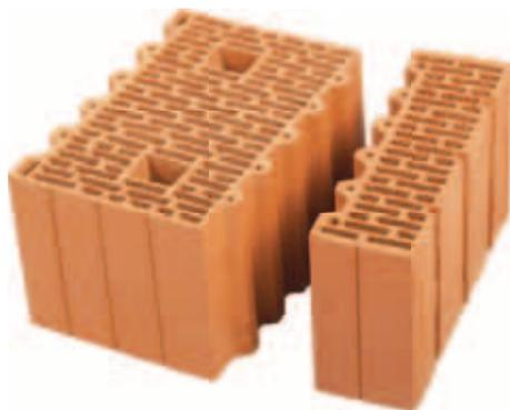
Porotherm 38 – стандартное решение для частного и многоэтажного домостроения. Используется для строительства наружных и внутренних стен, а также для заполнения монолитного каркаса. Применяется для строительства наружных стен зданий с несущими стенами до 5 этажей без дополнительного усиления кладки. Допускается использование материала без дополнительного утепления при условии отделки фасада облицовочным кирпичом. Высокий уровень звукоизоляции обеспечивает защиту от шума с улицы.
