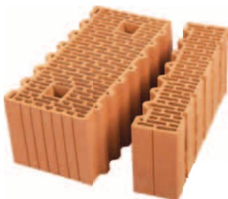
Porotherm 51 – оптимальное решение для частного и многоэтажного домостроения. Толщина стены, возведенной из блоков Porotherm 51, составит 510 мм. Стеновой материал не требует дополнительного утепления в большинстве регионов РФ. Применяется для строительства зданий с несущими стенами до 10 этажей без дополнительного усиления кладки, а также для заполнения монолитного каркаса. Высокий уровень звукоизоляции обеспечивает защиту от шума с улицы.
