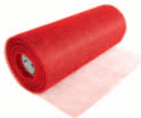
Кладочная сетка Porotherm JM укладывается в каждом ряду кладки из крупноформатных керамических блоков Porotherm с целью недопущения возможного проваливания кладочного раствора в большие пустоты, шириной более 10 мм.
