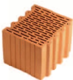
Porotherm 30 – крупноформатный блок для строительства внутренних несущих стен. Высокая прочность блоков М200 позволяет использовать их при строительстве зданий высотой до 10 этажей. Толщина стены, построенной из блоков Porotherm 30, составит 300 мм. Высокий уровень звукоизоляции обеспечивает защиту от шума между прилегающими помещениями.
