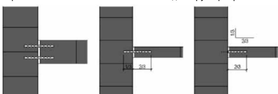
Пространство между последним рядом перегородки и потолком заполните раствором. Если пролет перекрытия превышает 3,5 м, заполните это пространство эластичным материалом из-за возможного движения перекрытия.
