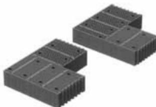
**Перевязка с внутренней стеной толщиной 380 мм**
