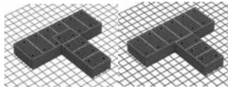
**Перевязка с внутренней стеной толщиной 250 мм**
