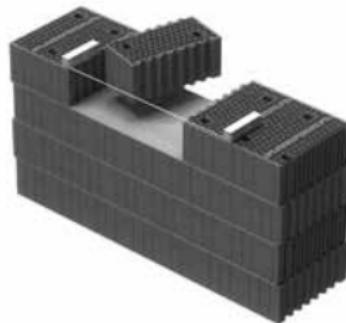
Перед нанесением раствора постельных швов под следующий ряд кирпича намочите верхнюю поверхность кирпичей последнего выложенного ряда. Консистенция кладочного раствора должна быть такой, чтобы раствор не затекал в вертикальные отверстия кирпичей!
