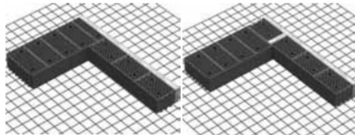
Внутренний угол наружной стены в месте соединения с внутренней стеной толщиной 250 мм
