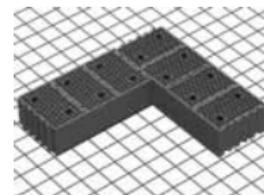
Перевязка с внутренней стеной толщиной 380 мм
