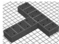
Перевязка с внутренней стеной толщиной 250 мм
