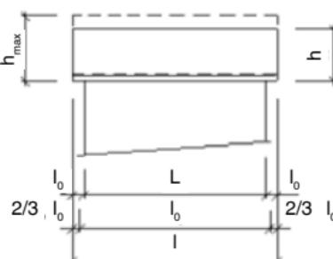
мычками – зоны распора – можно использовать обожженные, силикатные, бетонные кирпичи и блоки, поперечная прочность которых (т.е. после укладки над перемычками вдоль горизонтальных осей перемычек) составляет в среднем хотя бы 2,5 МПа, а по отдельности – хотя бы 2,0 МПа.
